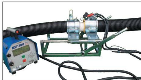
6. Совмещение и блокировка фиксаторов на сварочной раме.
